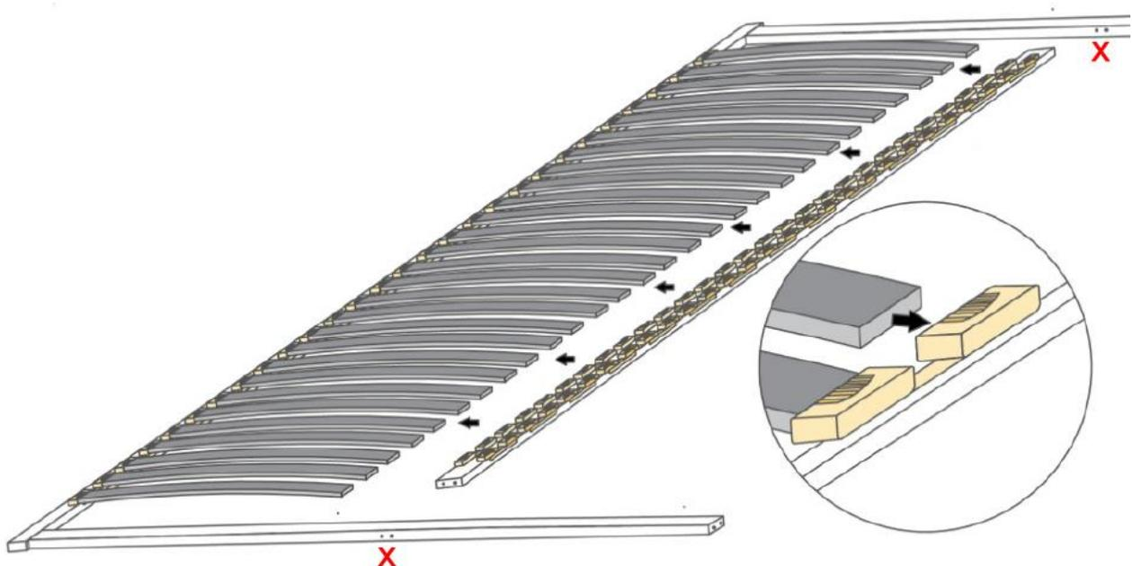
Verbinde bitte das Mittelstück (#2) mit den Federholzleisten und schraube den Mittelholm an den mit X-gekennzeichneten Stellen mit den Querstücken (#3) fest.
