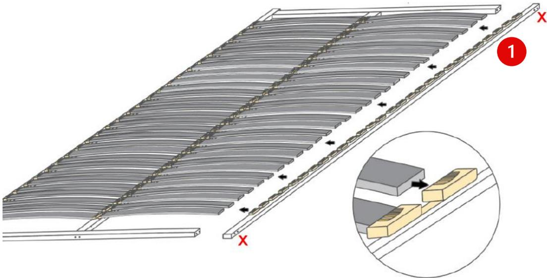
Verbinde das zweite Teilstück (#1) an den mit X gekennzeichneten Stellen, nachdem alle Federholzleisten zwischen Mittelholm (#2) und Teilstück (#1) stecken.
