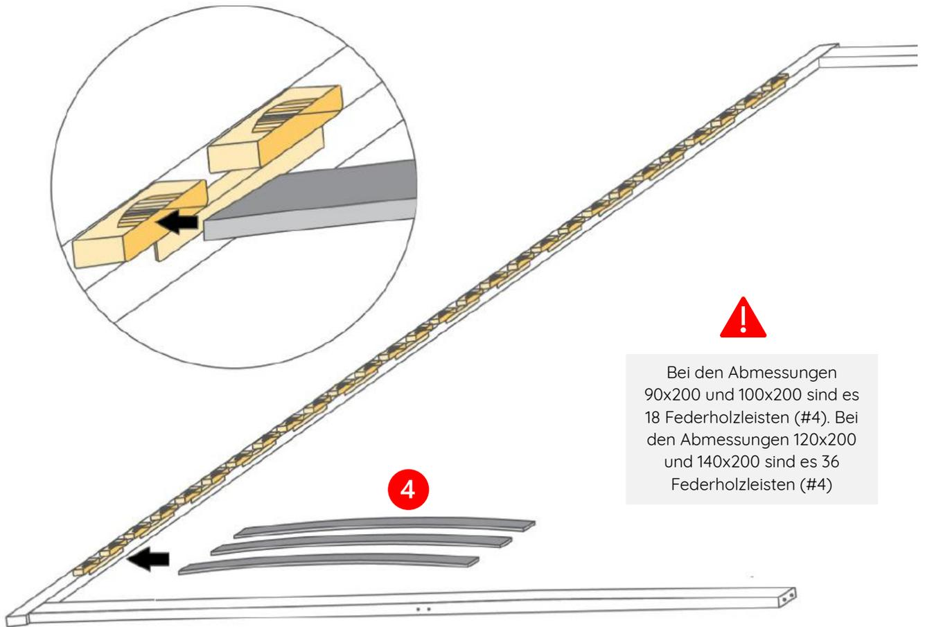
Stecke bitte nun die Federholzleisten (#4) in die Gummikappen. Damit die Verbindung mit dem zweiten Teilstück #1 später besser gelingt und alle Federholzleisten in den Gummikappen bleiben, empfiehlt es sich die gesamte Konstruktion aus Schritt 1 gegen eine Wand / Fußleiste zu legen.
